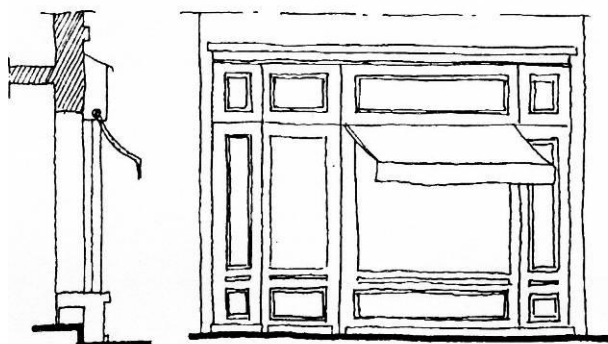
3- Store dissimulé dans le coffrage
